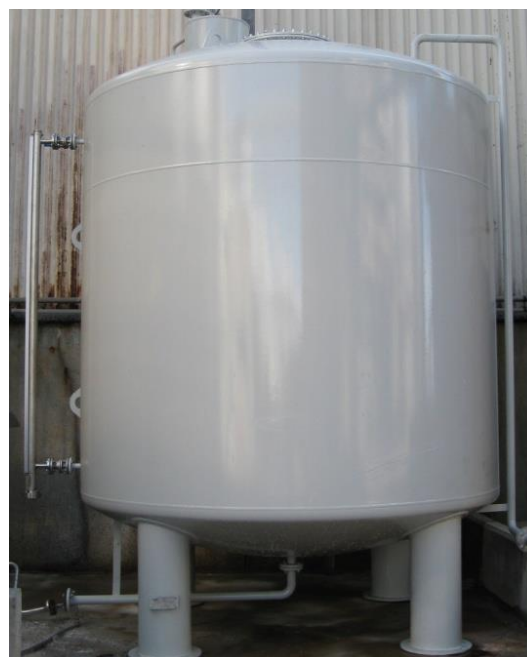
20 m 3 vertikal tank til svovlsyre inkl. tørrepotte, niveauiser, rustfrie ventiler m.m.
