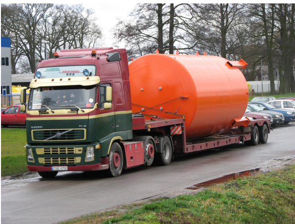
Vertikal tank på 51 m 3 med en diameter på 3200 mm
