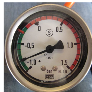
Kontaktmanometer med indbygget alarmpunkt for lækageovervågning
